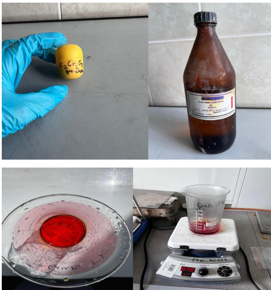
6 сурет-Хромпик ерітіндісін дайындау барысы. Азот қышқылы және калий карбонаты
